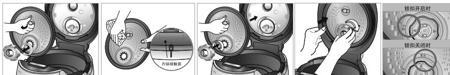
①向逆时针方向转动锁扣分离后可清洗。
